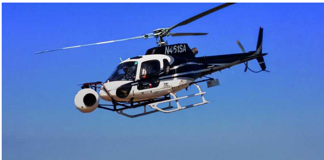
Obr. 24: ukázka helikoptéry s připojeným snímacím zařízením
