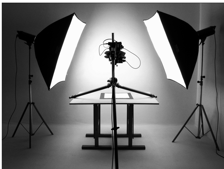
OBR 5.4.1 TYPICKÉ SYMETRICKÉ NASVĚTLENÍ VODOROVNĚ ULOŽENÉ PŘEDLOHY SOFTBOXY
